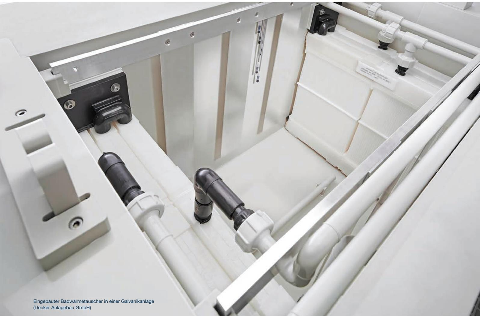
Eingebauter Badwärmetauscher in einer Galvanikanlage
