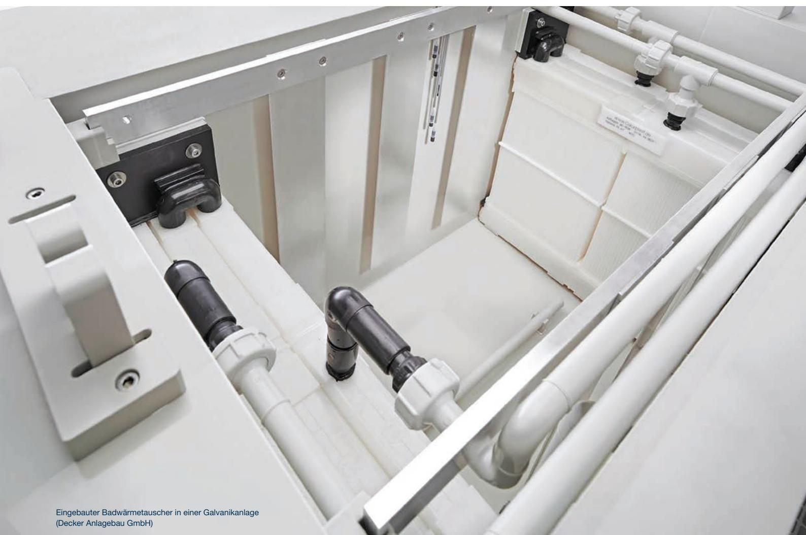
Eingebauter Badwärmetauscher in einer Galvanikanlage
